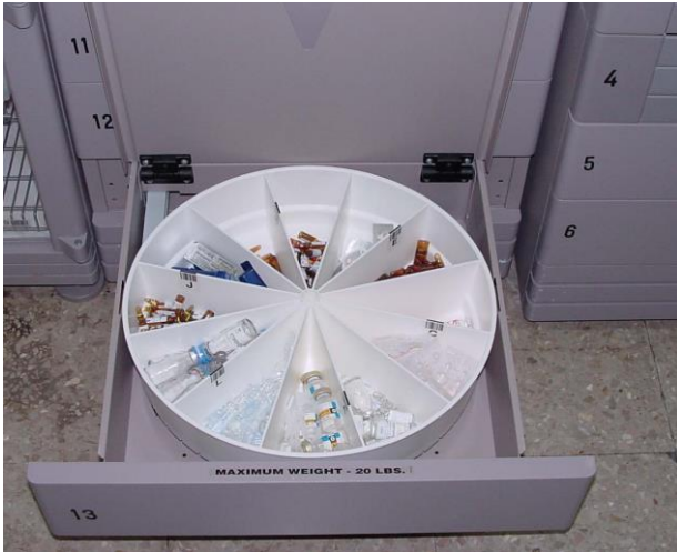
Figura 6. Espiral de dispensación utilizado en el SADME Autodrugs de KRZ®. Tomada de Hernández y Poveda (51)
