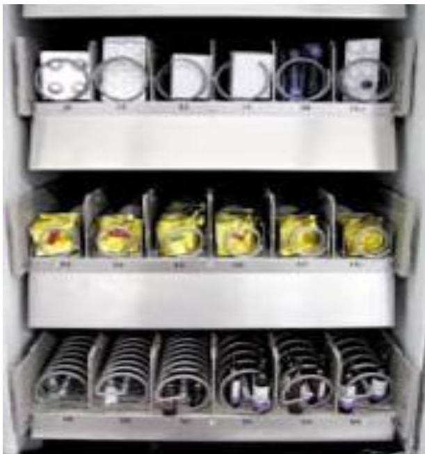
Figura 6. Espiral de dispensación utilizado en el SADME Autodrugs de KRZ®. Tomada de Hernández y Poveda (51)
